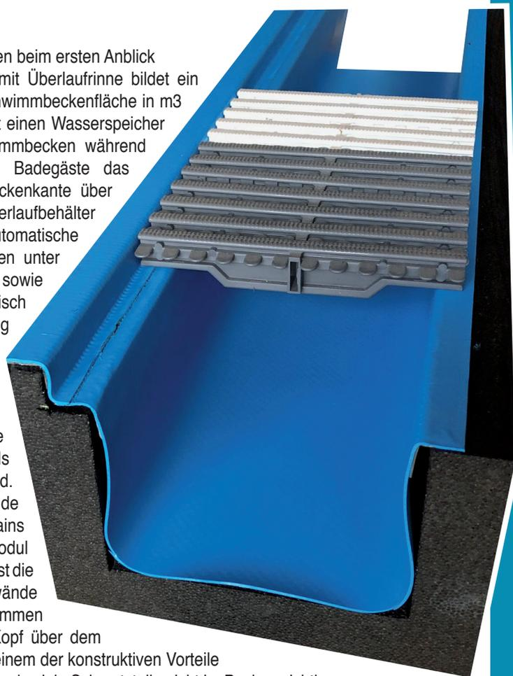
Das Überlaufsystem Modul LIGHT besteht aus EPS Partikelschaum das in drei verschiedenen Höhen einfach auf die Beckenkronen aufgesetzt wird. Im Gegensatz zur Modul Standard Rinne muss Modul LIGHT foliert werden.
